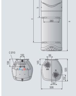
Diâmetros de conexão de condução de ar disponíveis de serie (in e out): Ø125 mm, Ø150 mm.
