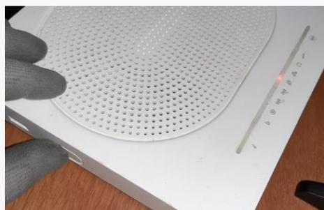
Figura 2 – Abrir a função WPS no router de sua casa carregando no botão respectivo; enquanto a rede estiver aberta piscará um LED no router
